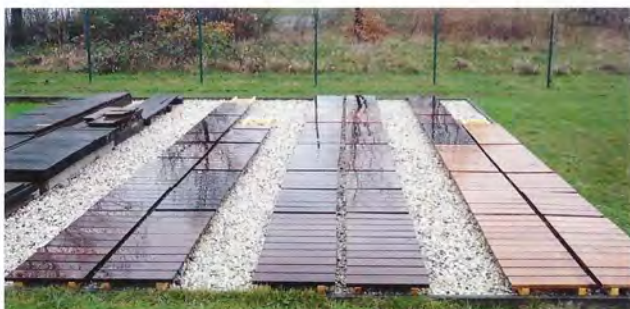
TMT-Varianten in Bewitterung auf dem IHD-Freilandversuchsfeld (regennass)
